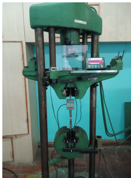
Рис. 3. Фрагмент определения усилия разрыва склеенных образцов
