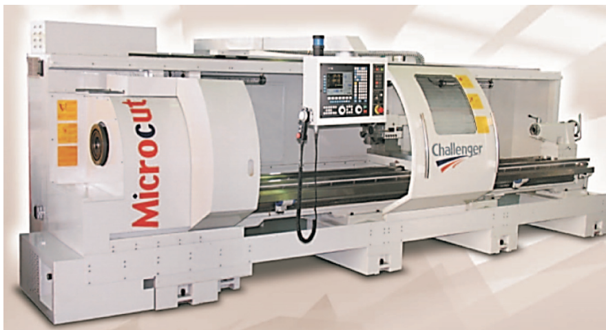
Рис. 5. Внешний вид трубонарезного станка с ЧПУ модели BNC 2840A
