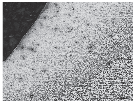
Рис. 9. Микроструктура боковой поверхности резьбы после ЭМО при увеличении \times 200
