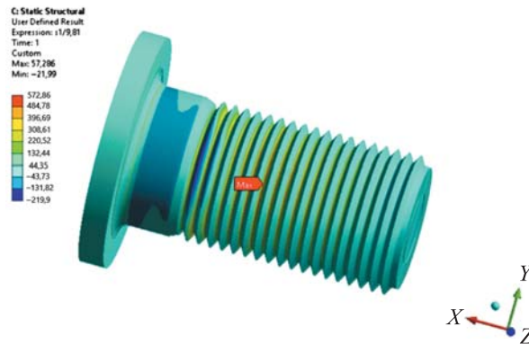
Рис. 4. Напряженно-деформированное состояние эталонной модели болта; приведены первые главные напряжения, МПа
