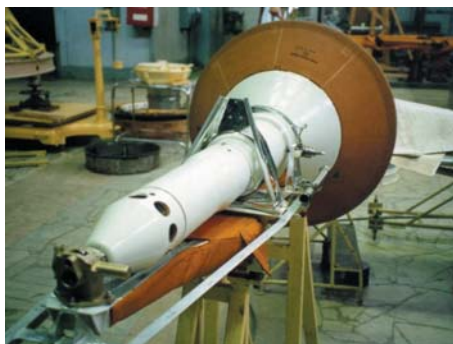
Рис. 1. Пенетратор проекта «Марс-96» при подготовке к установке на космический аппарат [5, 7]
