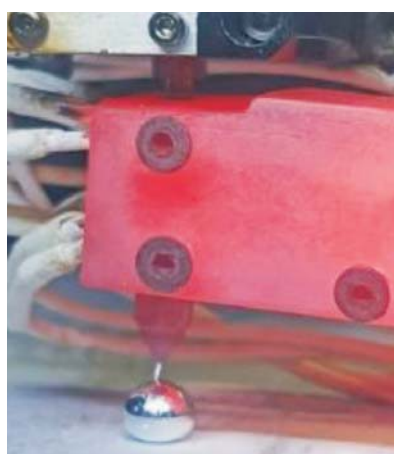
Рис. 12. Формирование металлической капли
