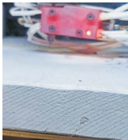
Рис. 9. Тестирование теплостойкости стола принтера Flying Bear S1
