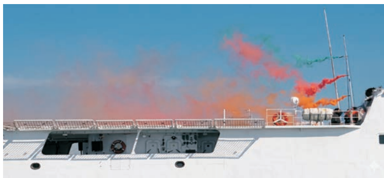
Рис. 1. Вихревое течение над ВППл судна
