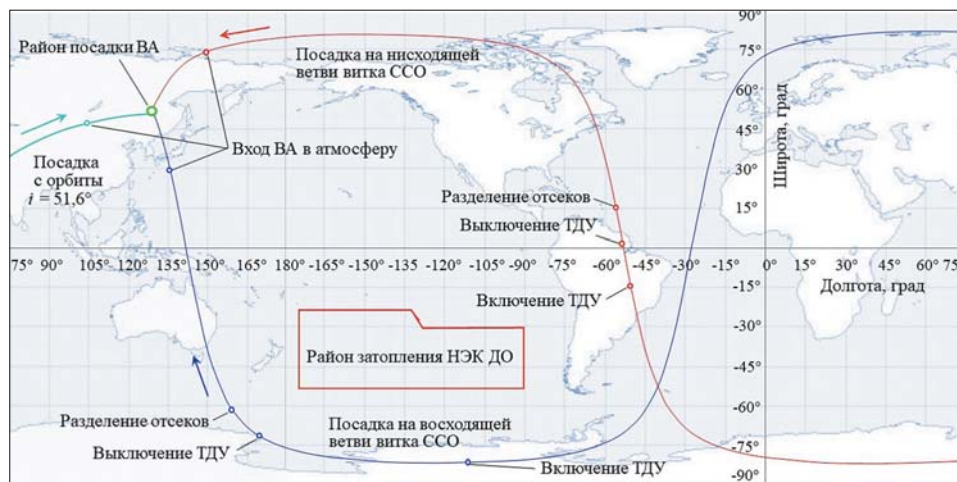
Рис. 5. Трассы посадочных витков
