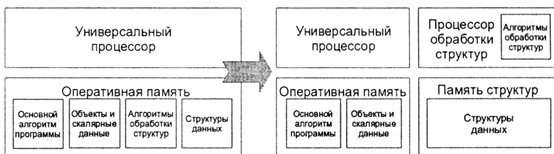
Рисунок 3. Универсальная ЭВМ, построенная по базовым принципам Фон-Неймана (слева) и вычислительная система с аппаратной поддержкой операций над множествами и структурами данных (справа)
