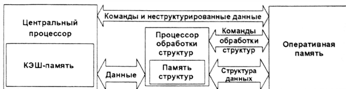
Рисунок 4. Взаимодействие устройств в вычислительной системе с аппаратной поддержкой операций над множествами и структурами данных
