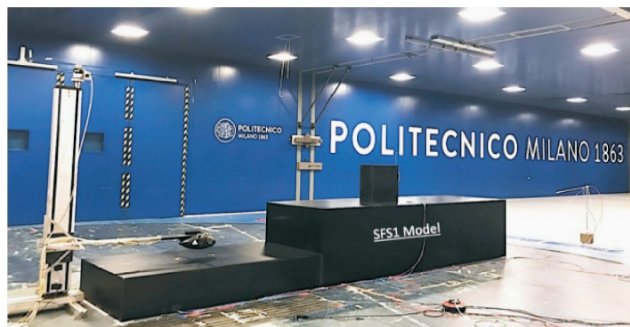
Рис. 6. Масштабные модели кормовой части корабля и вертолета для эксперимента, проводимого в аэродинамической трубе [3]
