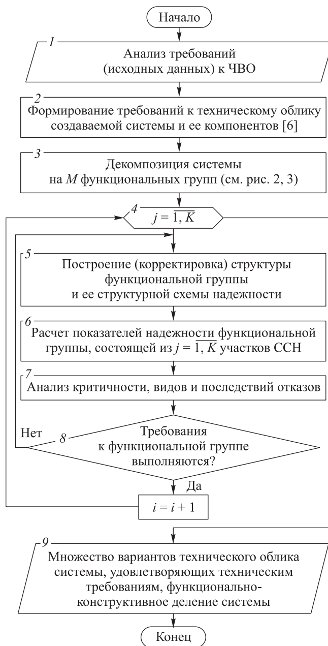
Рис. 4. Блок-схема алгоритма оценки показателей надежности систем ЧВО НКИ на основе функционального анализа
