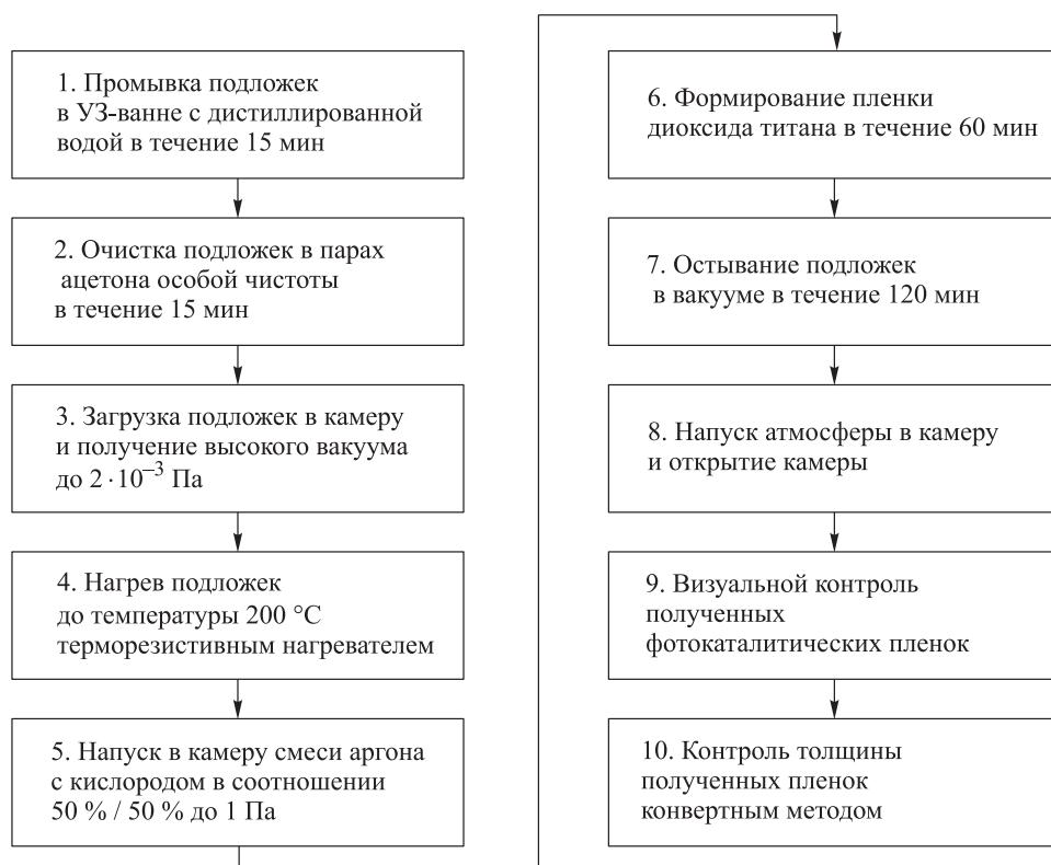
Рис. 1. Схема технологического процесса формирования фотокаталитических пленок \text{TiO}_2
