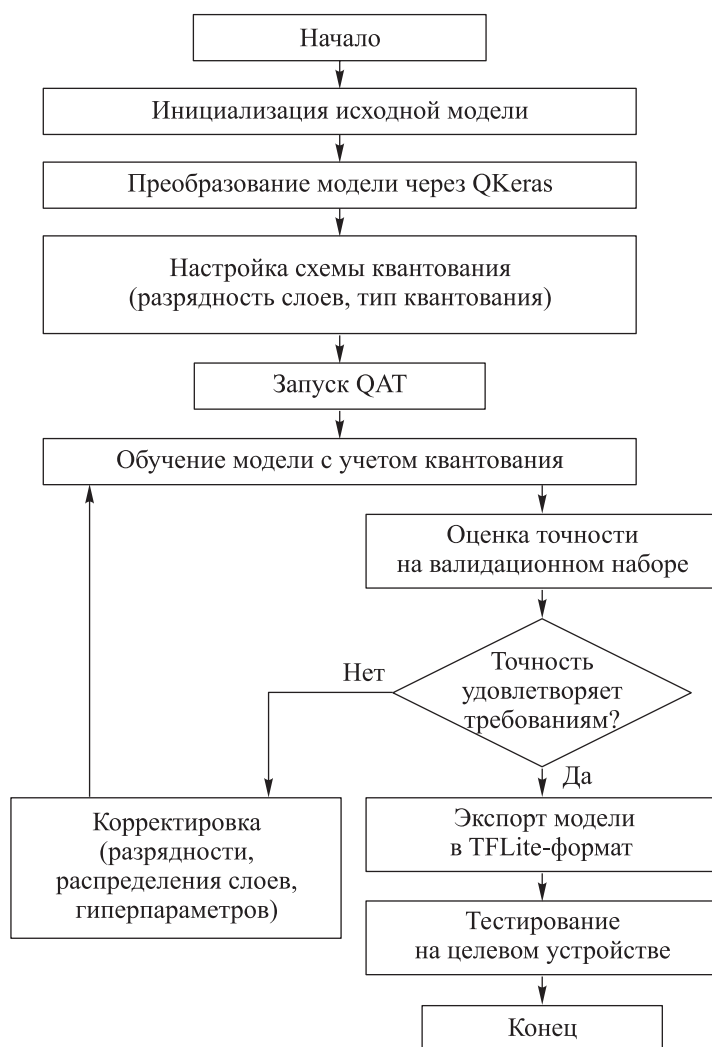
Рис. 1. Блок-схема алгоритма квантования с обучением
