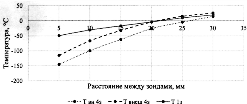
Рисунок 11. Температуры в контрольных точках для серии с 4 криозондами на 600 секунде расчета
