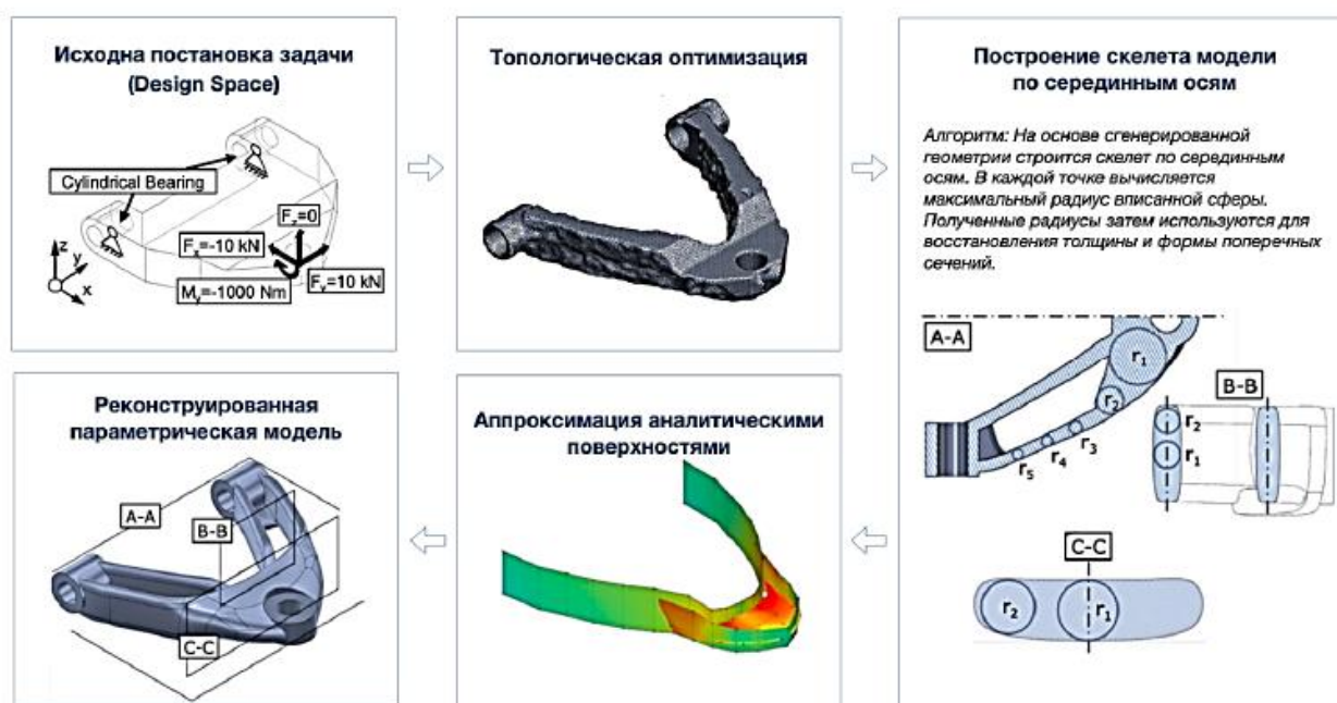
Рис. 2. Схема MAT-метода (Medial Axis Transform)
