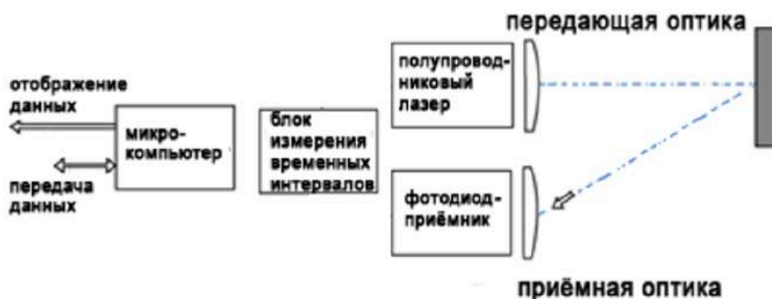
Рис. 1. Принципиальная схема работы лазерного сканера
