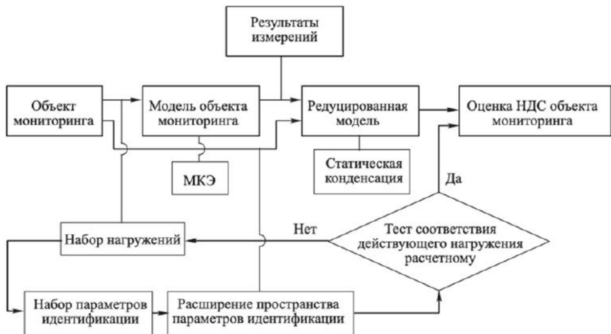
Рис. 2. Блок-схема алгоритма оценки НДС объекта мониторинга
