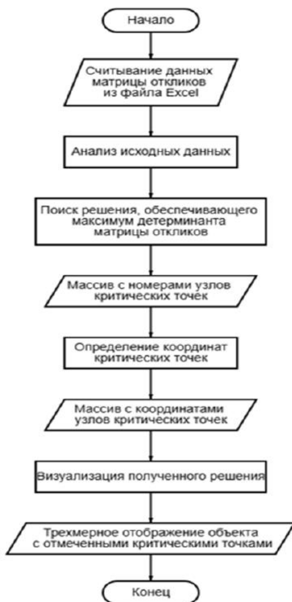
Рис. 3. Блок-схема алгоритма работы программы расчета рациональной конфигурации ИИС мониторинга
