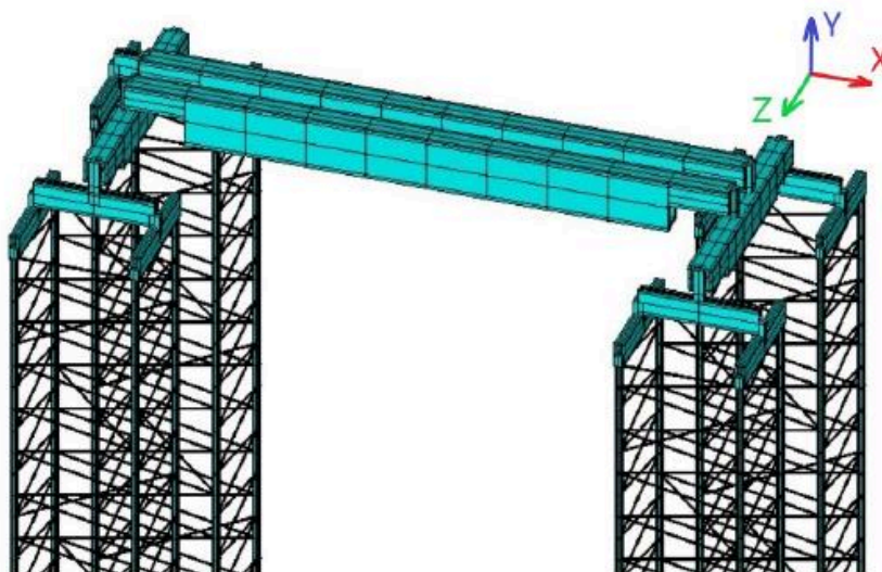
Рис. 4. Пролетное строение крана — конечно-элементная модель
