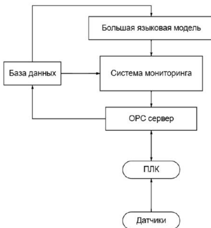
Рис. 2. Структурная схема системы с использованием большой языковой модели
