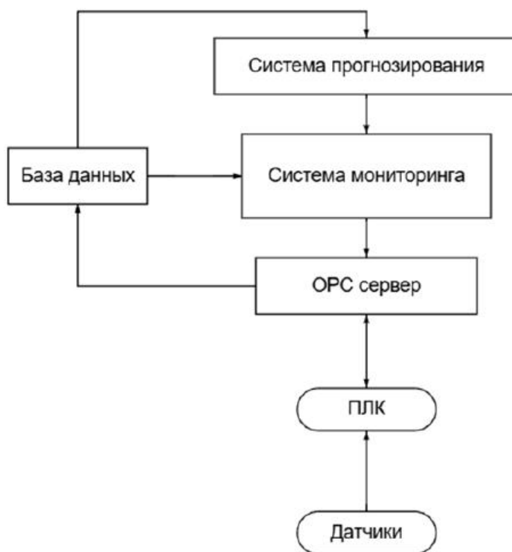
Рис. 1. Структурная схема системы с предиктивным обслуживанием
