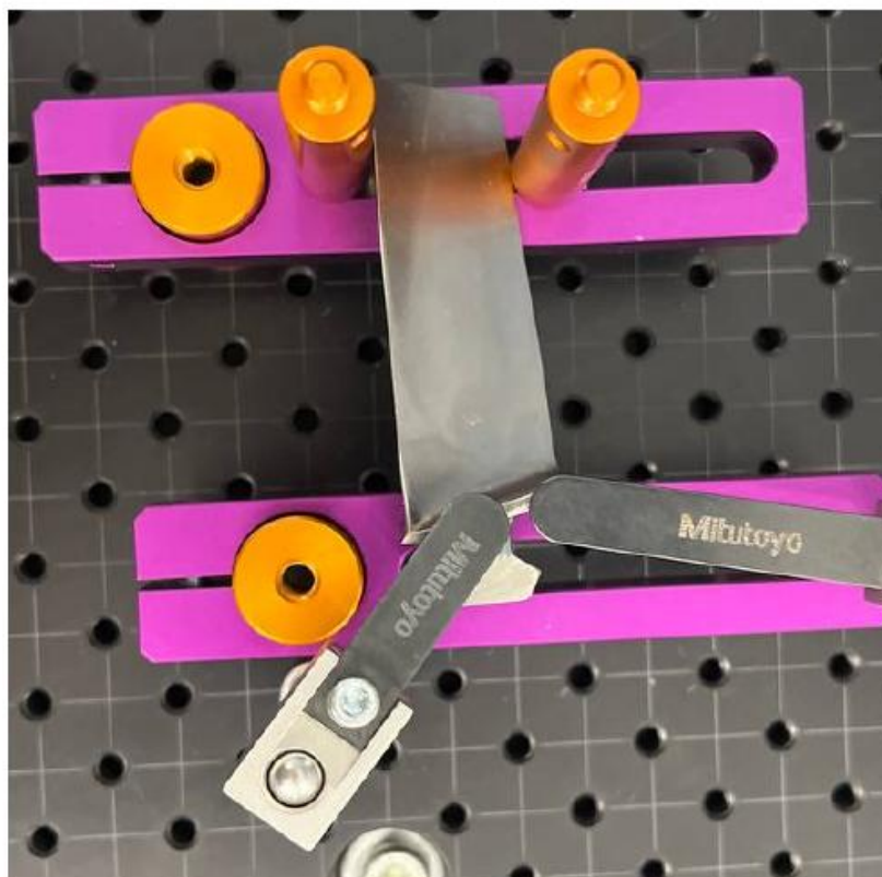
Рис. 2. Лопатка, закрепленная прижимами
