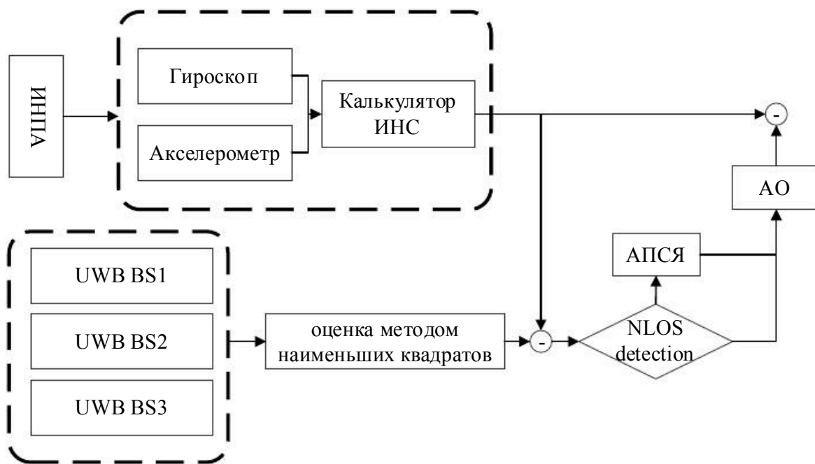
Рис. 1. Алгоритм, обеспечивающий оптимальную оценку положения беспилотного аппарата
