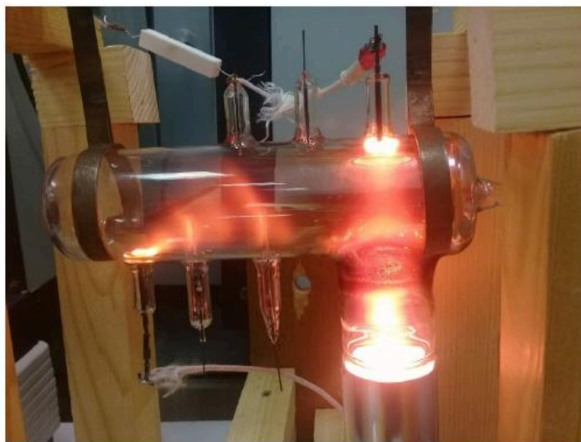
Рис. 3. Страты He-Ne плазмы при w = 9 \cdot 10^4 Вт/м 3
