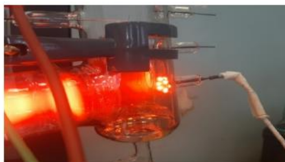
Рис. 2. Наблюдаемые разряды (а) стратифицированный разряд и эффект контракции на аноде А2 при удельной мощности 78,8 кВт/м 3 (б)
