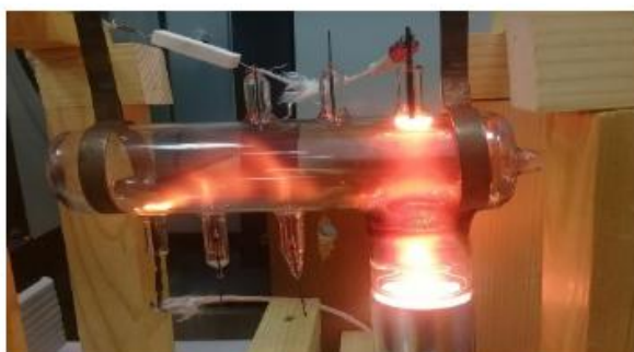
Рис. 2. Наблюдаемые разряды (а) стратифицированный разряд и эффект контракции на аноде А2 при удельной мощности 78,8 кВт/м 3 (б)
