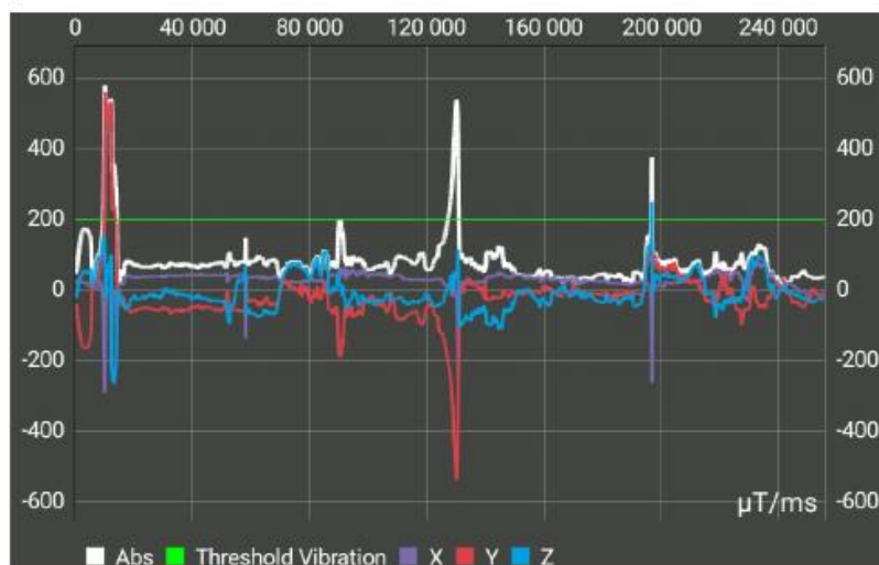
Рис. 2. Осциллограмма вращающегося магнитного поля в салоне вагона метро
