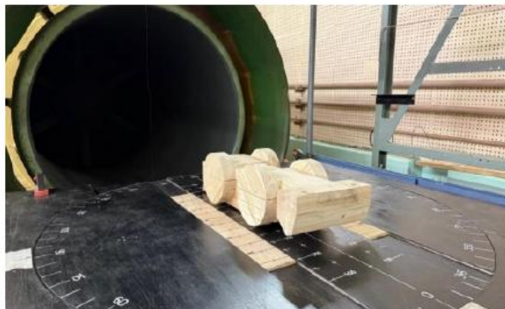
Рис. 2. Установка модели на поворотном круге в рабочей зоне АДТ
