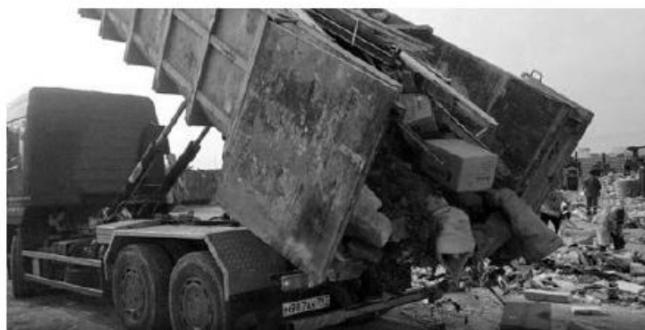
Рис. 1. Выгрузка ТКО из автомобиля с системой «мультилифт»
