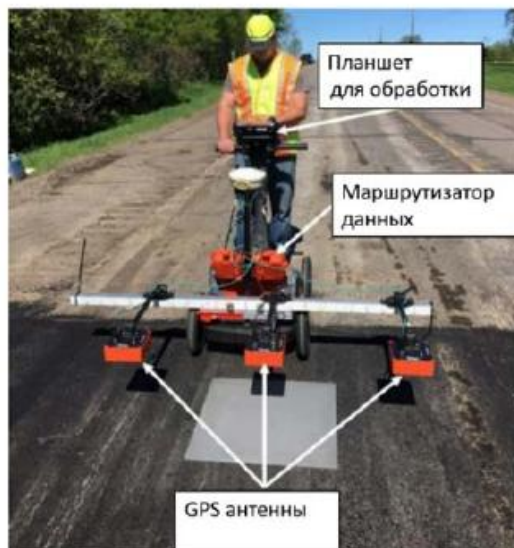
Рис. 4. Измерение степени уплотнения георадаром
