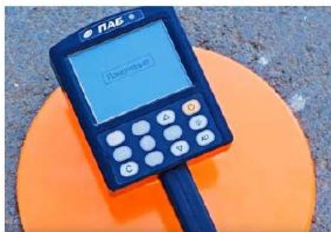
Рис. 6. а — измерение степени уплотнения переносным плотномером ПАБ-1; б — измерение степени уплотнения переносным плотномером ПА-МГ4
