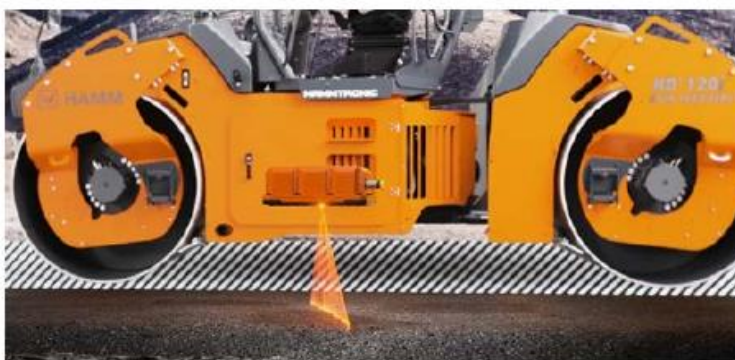
Рис. 5. Измерение степени уплотнения георадаром на катке НАММ
