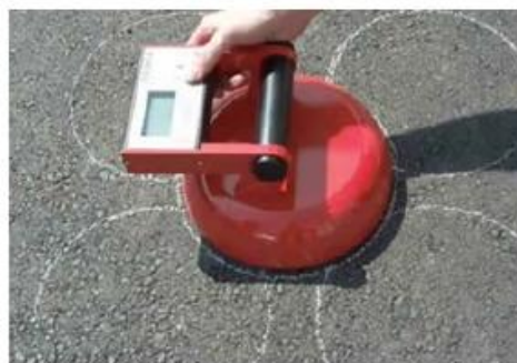
Рис. 6. а — измерение степени уплотнения переносным плотномером ПАБ-1; б — измерение степени уплотнения переносным плотномером ПА-МГ4
