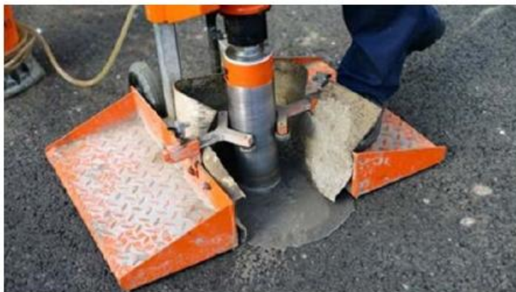
Рис. 1. Отбор керна из асфальтобетонного покрытия GOLZ KB200 «НИИ ЛАДОР»
