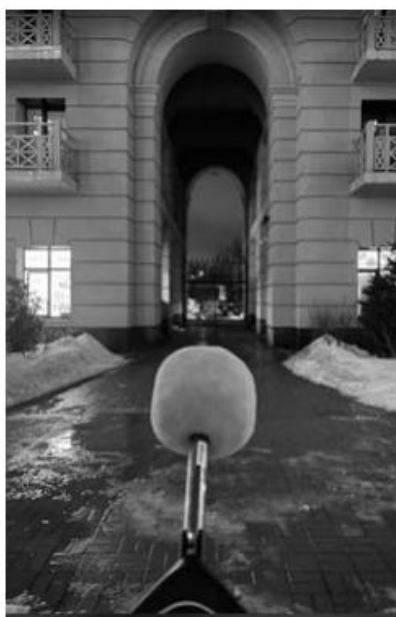
Рис. 4. Пример эффективной конструкции жилого здания (с точки зрения защиты от шума придомовой территории), измерение шума на площадке отдыха внутри двора
