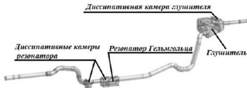
Рис. 7. Модель СВОГ с резонатором и диссипативными элементами
