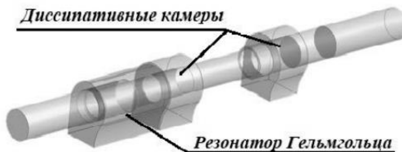
Рис. 3. Модель анализируемого резонатора с диссипативными камерами
