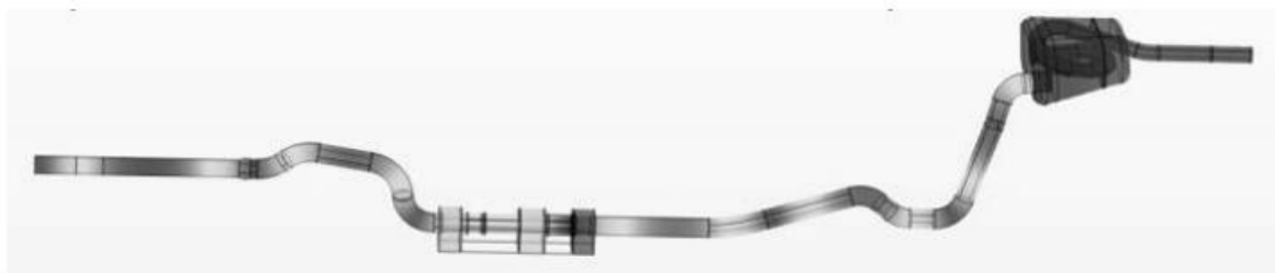
Рис. 10. Распределение звукового давления вдоль СВОГ на частоте 330 Гц
