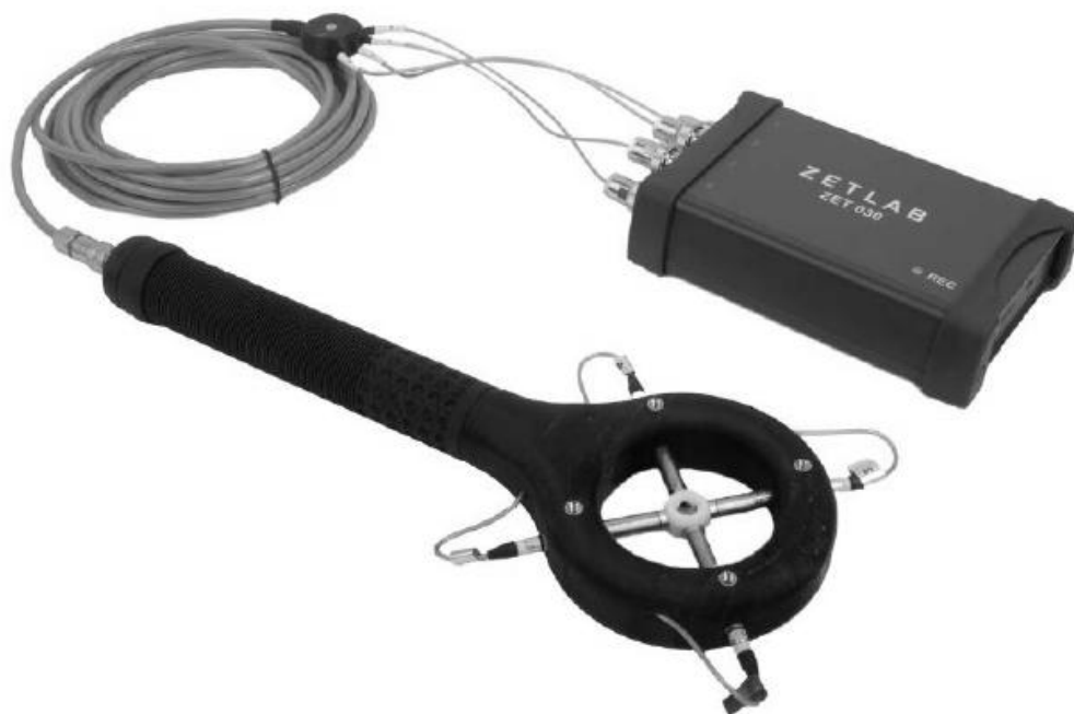
Рис. 1. Общий вид интенсивметрического зонда с четырехмикрофонной конфигурацией
