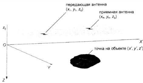
Рис. 1. Геометрия системы для регистрации радиоголограмм
