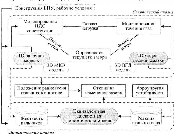
Рис. 2. Математическое моделирование работы БПУ: взаимосвязи и иерархия моделей разного уровня
