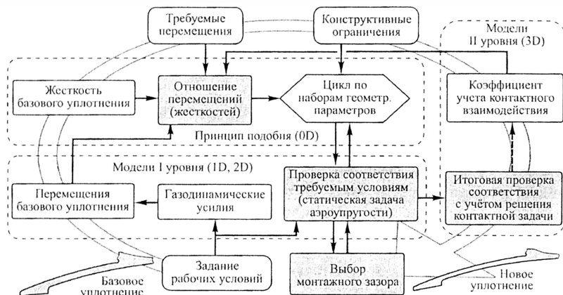
Рис. 8. Алгоритм решения обратной задачи МДТТ для БПУ
