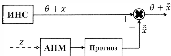
Рис. 4. Функциональная схема коррекции с алгоритмом прогноза
