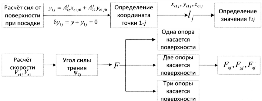
Рис. 6. Схема алгоритма определения сил реакции поверхности
