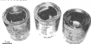
Рис. 11. Опытные образцы заготовок поршня КАМАЗ 7405 из сплавов АЛ25, В96Ц3 и АК4-1
