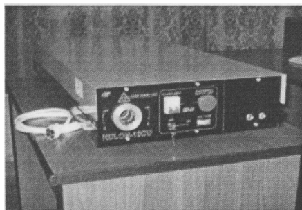
Рис. 11. Промышленные ЛПМ «Кулон 05» (а) и «Кулон 06» (б) с управляемой мощностью и ЧПИ излучения. Патенты РФ: № 2226022 и № 2251179
