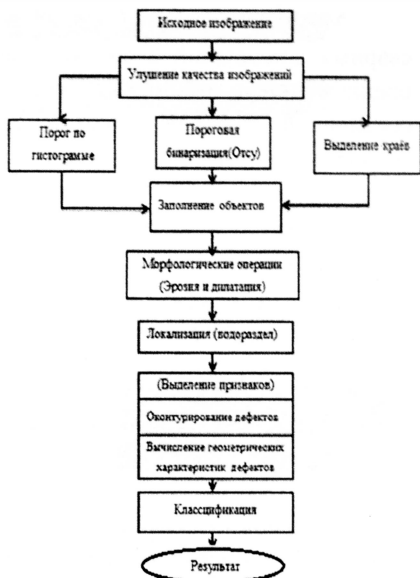
Рисунок 16 - Алгоритм локализации и классификации дефектов сварного шва
