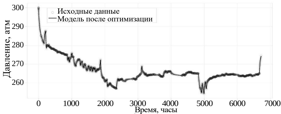
Рис. 3. Результат поиска параметров модели при переменном дебите
