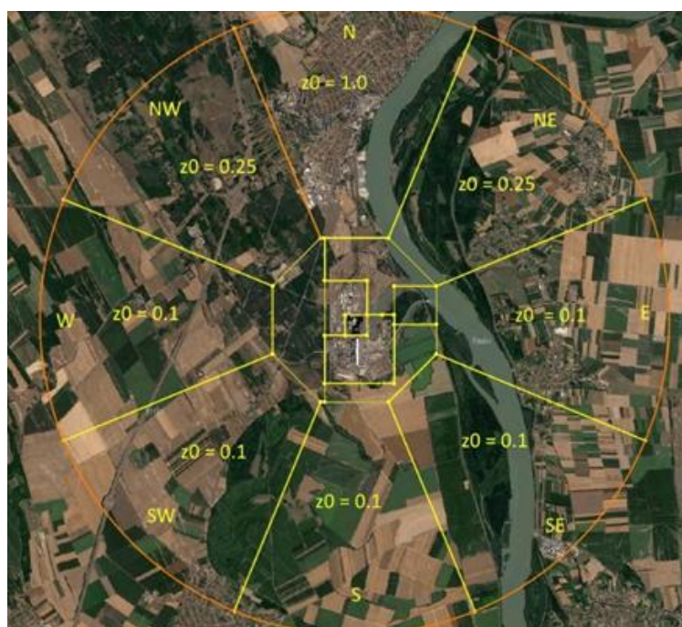
Рис. 7. Величины аэродинамической шероховатости согласно анализу аэрокосмического снимка, прилегающей к площадке Пакш-II территории
