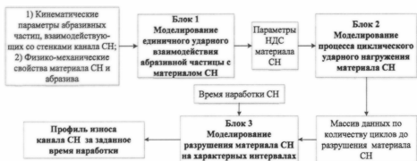
Рис. 5. Блок-схема математической модели разрушения канала СН
