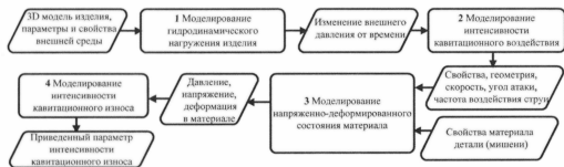
Рис. 1. Алгоритм теоретической оценки кавитационного износа деталей
