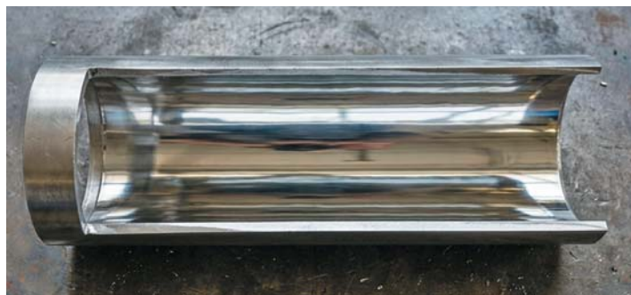
Рис. 1. Образец разрезанного цилиндра ПГШН с хромовым покрытием
