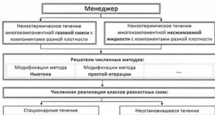
Рис. 3. Блок-схема компьютерной реализации численных методов моделирования течения сред по разветвленным трубопроводным системам
