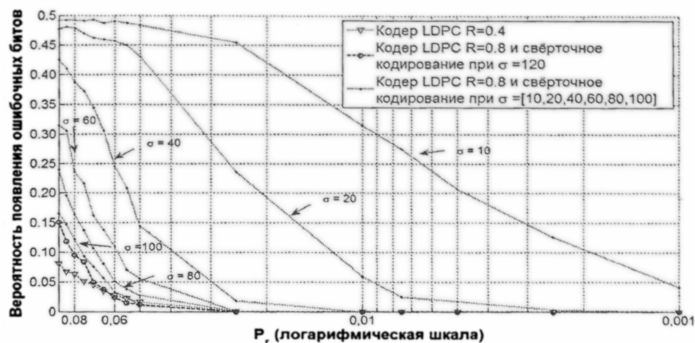
Рис. 6. Эффективность 1-ой и 2-ой схем при P_d = 0 и разных значениях \sigma
