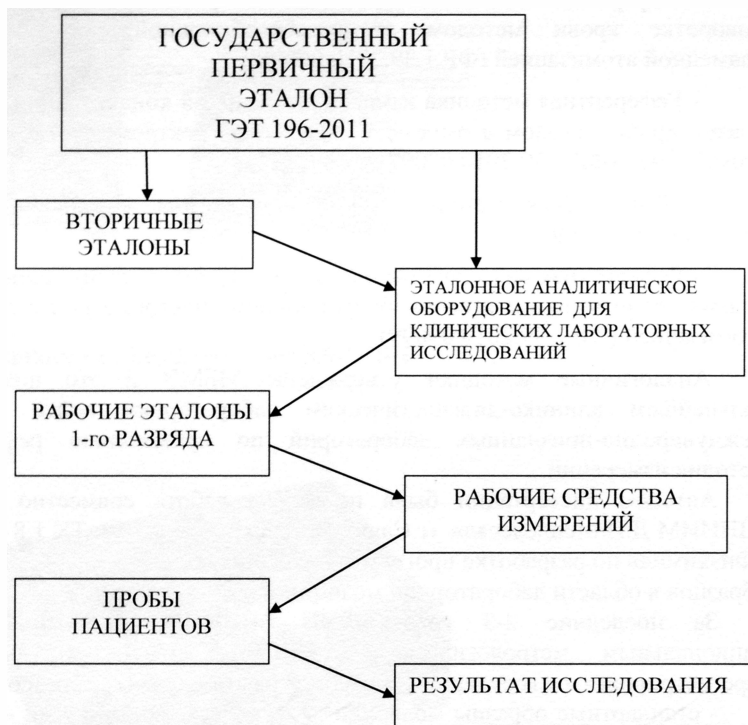
Рис.5. Схема воспроизведения и передачи единиц физических величин для обеспечения единства измерений для целей клинической лабораторной диагностики
