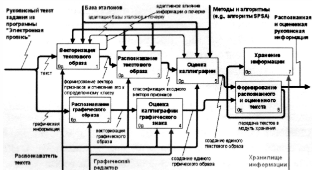
Рисунок 9. Первый уровень декомпозиции работы программно-аппаратного комплекса
