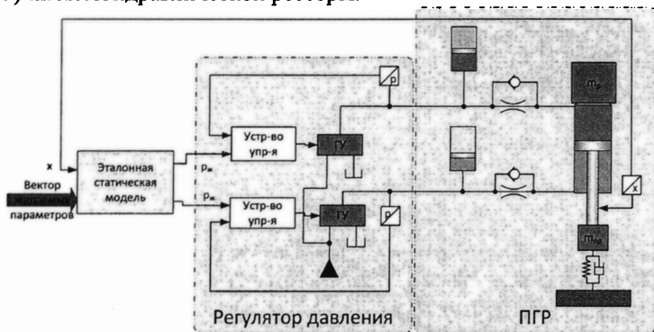
Рис. 5. Структурная схема системы автоматического регулирования пневмогидравлической рессоры
