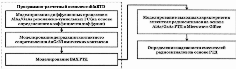
Рисунок 6. Структурная схема методики прогнозирования надежности смесителей радиосигналов на основе AlAs/GaAs РТД
