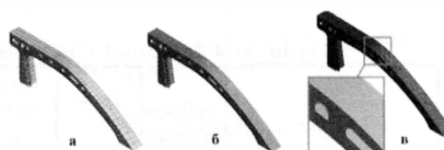
Рис. 4. Оболочечные КЭМ стойки: а – «низший уровень»; б – «средний уровень»; в – «высший уровень»
