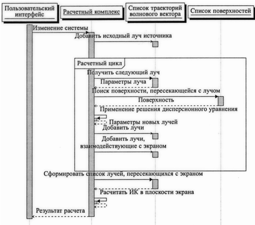
Рис. 1. Диаграмма последовательности процесса расчета оптической системы на языке UML
