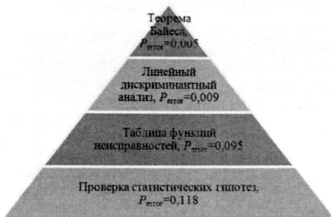
Рис. 14. Диаграмма сравнения алгоритмов диагностирования подклассов \omega_{13} и \omega_{21} , (режим стартерной прокрутки)
